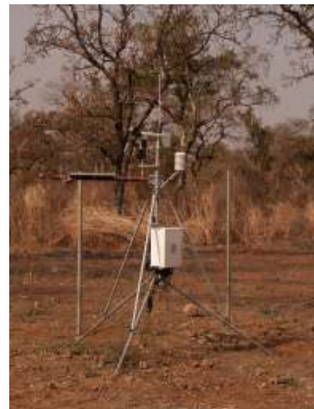
Image 63 : Station météorologique automatique dans le parc
